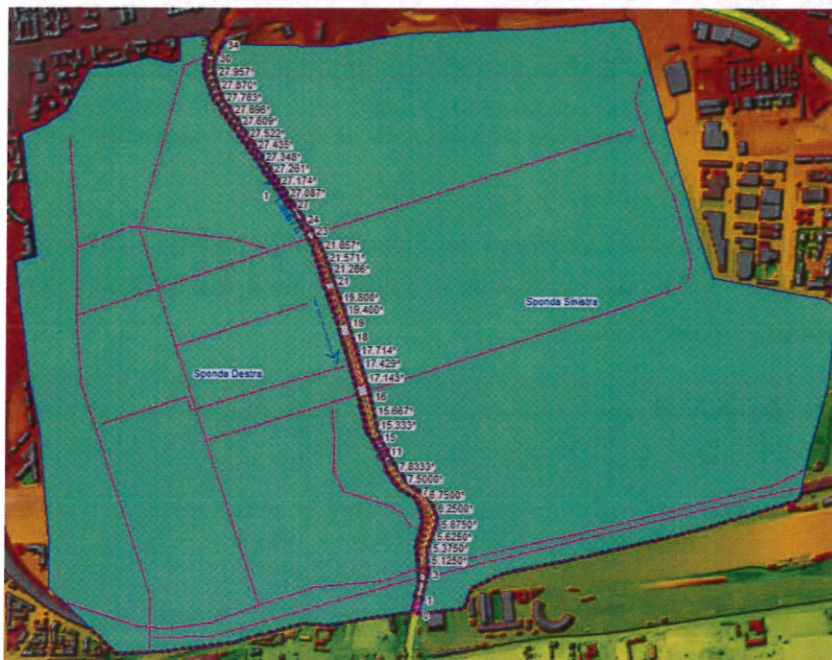
Vista delle Break Lines definite nel modello HEC-RAS all'interno delle aree di flusso esterne all'alveo.
